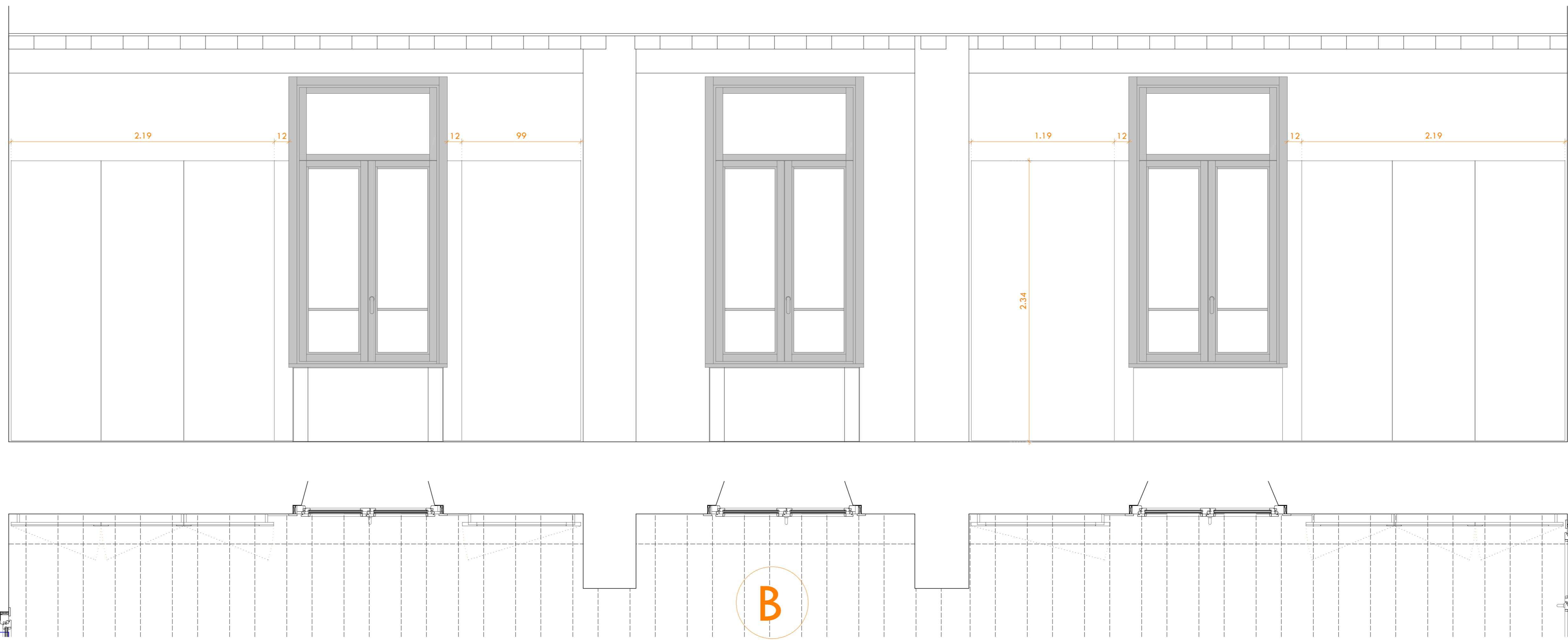
BOISERIE : SALA ESPOSITIVA _ PROSPETTO e PIANTA - lato B
