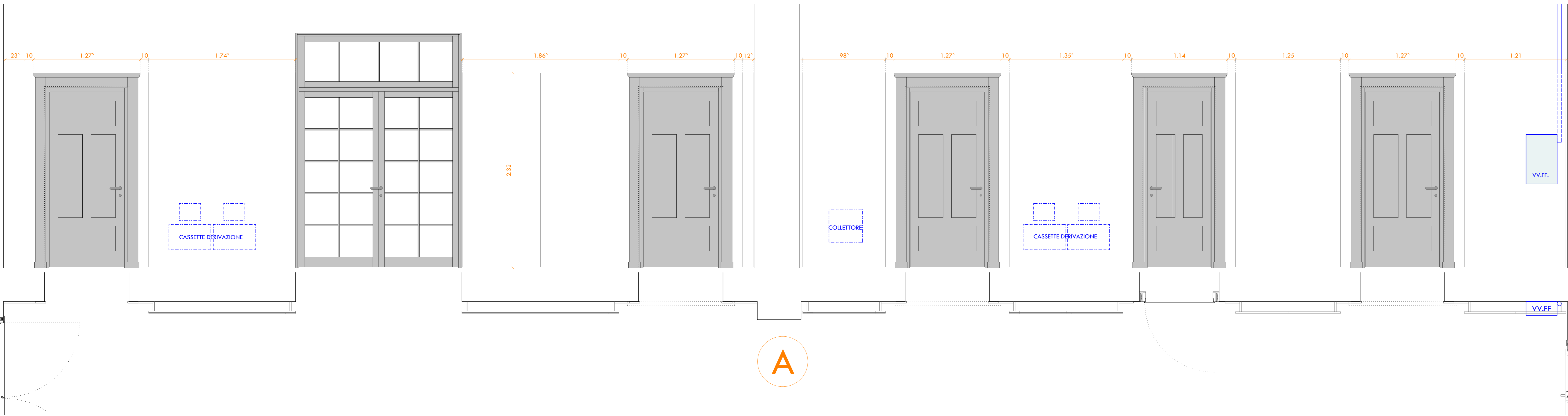
BOISERIE : CORRIDOIO PIANO TERRA _ PROSPETTO e PIANTA - lato A
